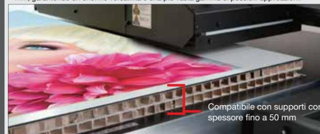
Compatibile con supporti con spessore fino a 50 mm
